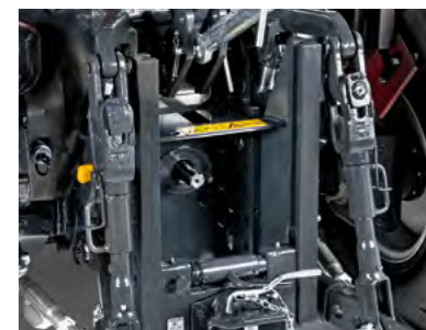
GANCHO SLIDER Integrado en el elevador trasero, ofrece al operador varias posiciones para complementar el tractor con facilidad y alinear rápidamente el implemento arrastrado.
