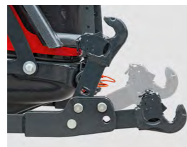
ELEVADOR DELANTERO El elevador delantero permite labores en combinación con los equipos traseros.
