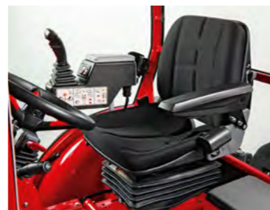
ASIENTO CONFORT De suspensión neumática, con indicador de carga y brazos.
